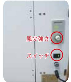
クリーンユニットのスイッチを ON にします。ポリウムで風の強さを調整してご使用下さい。
